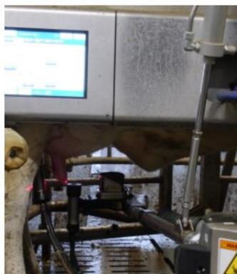
Technik pur: der Melkroboter mit Kamera.
